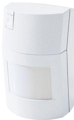
Il funzionamento con due tecnologie di rilevazione garantisce la massima sicurezza ed affidabilità. La rivelazione ad infrarossi passivi analizza la variazione di radiazione infrarossa in ogni occasione di movimento; la rivelazione a microonde conferma la rivelazione infrarossa tramite l'analisi della velocità di spostamento di una persona.
