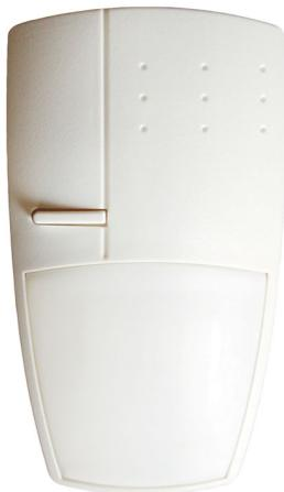
A **infrarossi passivi** con filtraggio della rilevazione, il rivelatore a infrarossi volumetrico **segnala le intrusioni analizzando la variazione di radiazione infrarossa che si verifica in occasione di ogni movimento**. La sensibilità è programmabile a 2 livelli ed è inoltre dotato di contaimpulsi programmabile e pulsante di test per verificare il corretto funzionamento e la rilevazione.
