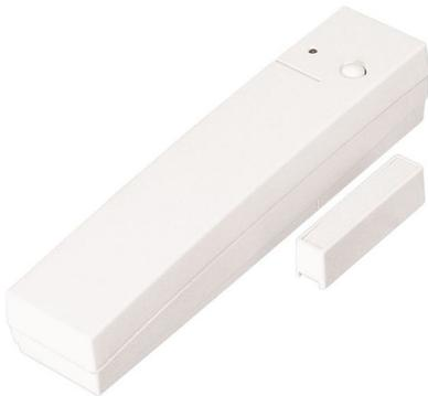
Dotato di contatto reed interno e magnete per installazione diretta su porte e finestre; integra due ingressi indipendenti a morsetti per la gestione di sensori esterni (NA, NC e contatti veloci). La sollecitazione degli ingressi può determinare uno dei qualsiasi segnali/comandi gestiti dal sistema (ON/OFF, Allarme, ecc.). Attivando il contatto reed incorporato si disattiva il morsetto 1.
