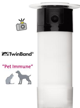
Il rivelatore di movimento con fotocamera da esterno antimask "Pet immune" **SH156AX** è composto da un infrarosso passivo orientato orizzontalmente e uno regolabile verso il basso su quattro portate possibili (4 - 8 - 12 - 15 m).
