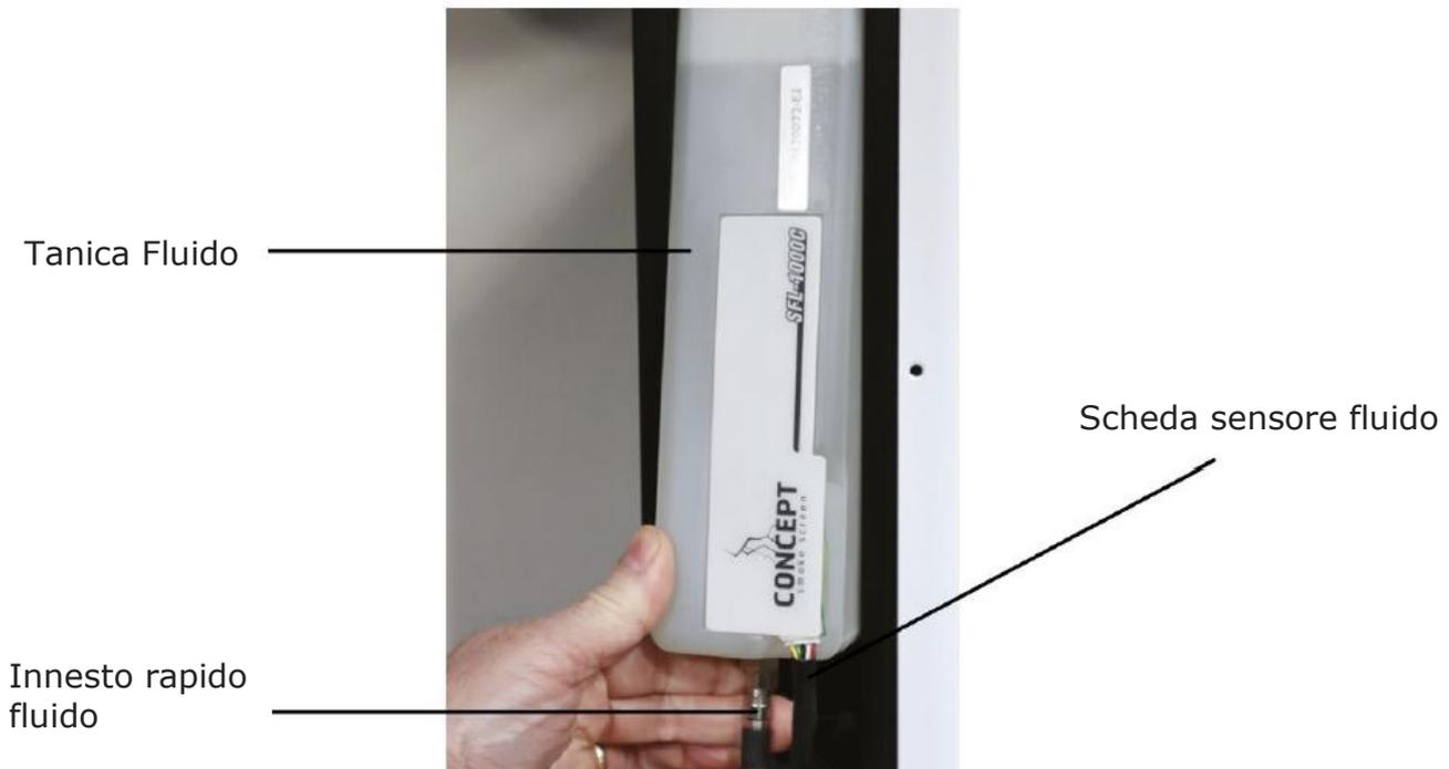
**QUANDO VIENE MONTATO UN NUOVO CONTENITORE DEL FLUIDO, LE BATTERIE DEVONO ESSERE CARICHE COSICCHÉ ALIMENTINO IL SISTEMA NEBBIOGENO, PER CONSENTIRE IL RESET DEL TIMER DEL FLUIDO.**
